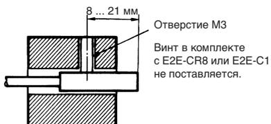
Максимальный крутящий момент затяжки должен составлять 0,2 Н·м для фиксации датчика E2E-CR8 и 0,4 Н·м - для фиксации датчика E2E-C1.
