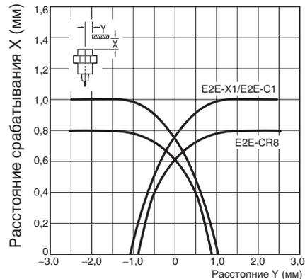
Зависимость расстояния срабатывания от размера и материала обнаруживаемого объекта (типовая)
