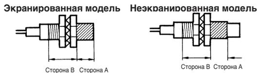
**Примечание:** В приведенной ниже таблице указаны значения крутящего момента затяжки гаек со стороны А и со стороны В. На приведенных выше рисунках гайка находится со стороны головки датчика (сторона В), поэтому применяется значение крутящего момента затяжки для стороны В. Если бы гайка находилась со стороны А, следовало бы применять значение крутящего момента затяжки для стороны А.
